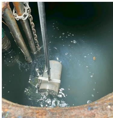
รูปที่ 3.4 ภาพแสดงการเก็บตัวอย่างน้ำจุดที่ 3 บริเวณบ่อพักน้ำสุดท้ายของระบบระบายน้ำของโครงการก่อนระบายลงสู่ระบบระบายน้ำบริเวณด้านหน้าโครงการ
